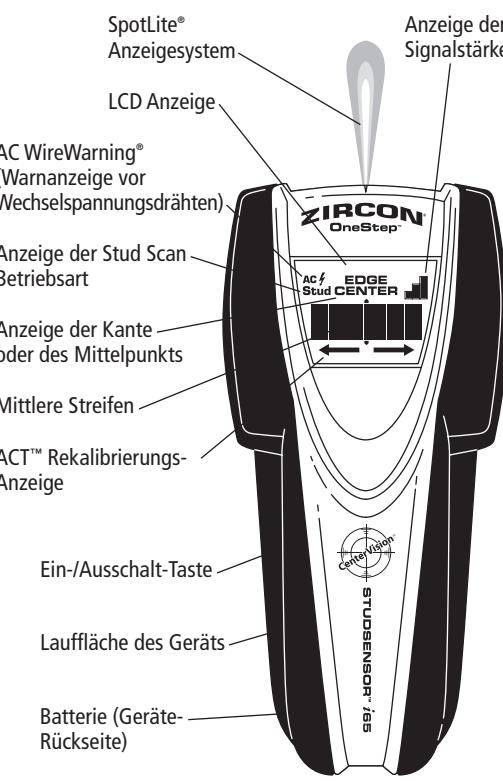
Das Ortungsgerät StudSensor™ i65 OneStep™ ortet den Mittelpunkt und die Kanten von Holzbalken und Metallverstrebungen in Wänden, Böden und Decken in nur einem Arbeitsschritt. Es ist ausgestattet mit einem beständigen, schlagresistentem Gehäuse, einem Lichtsignal, der auf das Ortungsziel zeigt, und der Funktion zur Erkennung von spannungsführenden Leitungen, die während des Scannens kontinuierlich auf vorhandene Stromleitungen hinweist.
