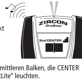
Sobald der Mittelpunkt des Pfostens mit drei Balken auf der Signalstärkeanzeige geortet ist, ertönt der Summer und die vier mittleren Balken, die CENTER Anzeige und das SpotLite® leuchten.
